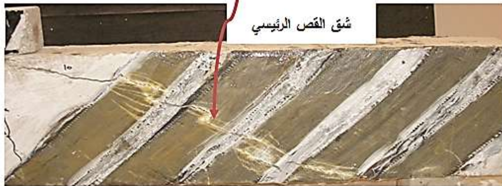
نموذج انهيار الجوائز المقوى بشرائح بزواوية 45 (B-45)
