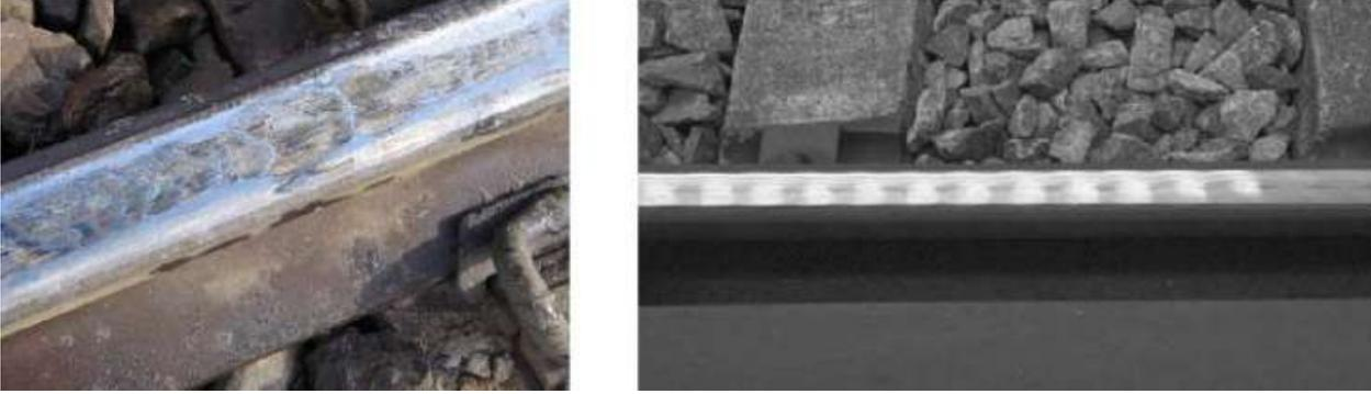
الشكل (1) - التآكل الحاصل على الخط الحديدي نتيجة بقاء الرمل
