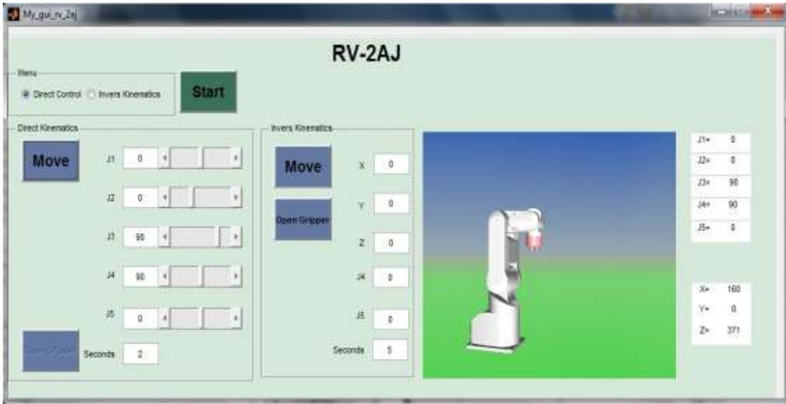
الشكل(6) واجهة الـ GUI المصممة للتحكم بنموذج الروبوت المقترح
