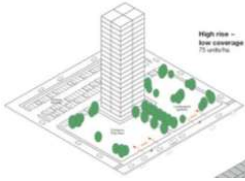
الشكل (6-ب) بناء سكني متعدد الطوابق عالي الارتفاع ونسبة بناء منخفضة للموقع
