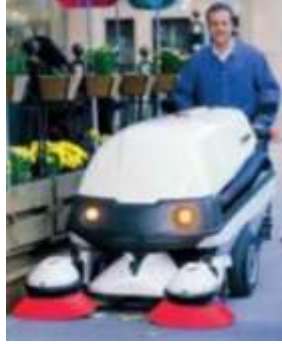
الشكل (7): استخدام آلة الفاكيوم في تنظيف البيتون النفوذ
