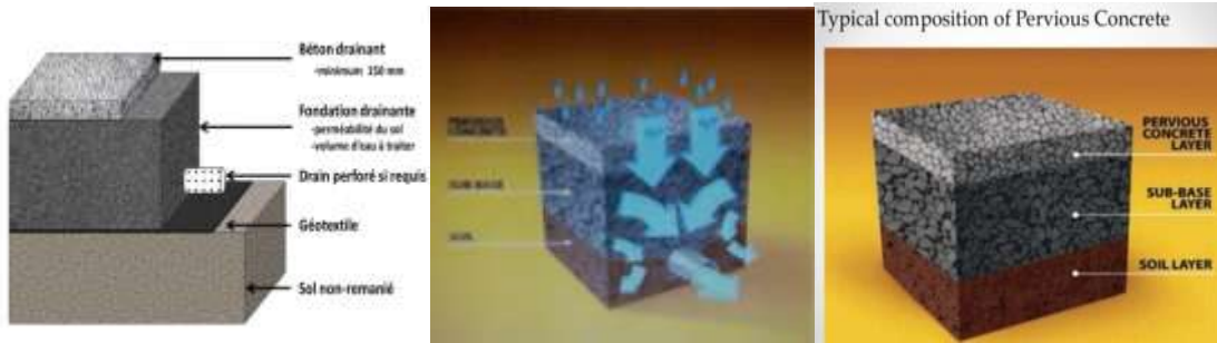
الشكل (5): طبقات الرصف باستخدام البيتون النفوذ
