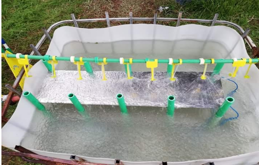
الشكل (2) خلية الوقود الميكروبية لطبقة الرواسب (SMFC) مع نمط التهوية الأول المستخدم
