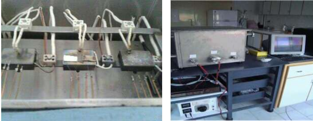
الشكل(1): صورة عامة لجهاز القياسات الكهربائية (المنحنيات المميزة) والحجرة الغازية الموجود في الطاقة الدرية بدمشق.
