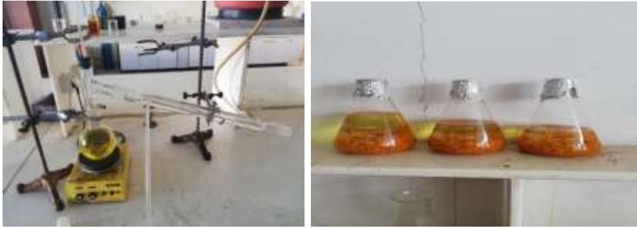
الشكل (1) يوضح عملية النقع وفصل الزيت باستخدام جهاز التقطير البسيط
