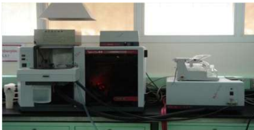
الشكل (3) جهاز الامتصاص الذري نوع Varian 220
