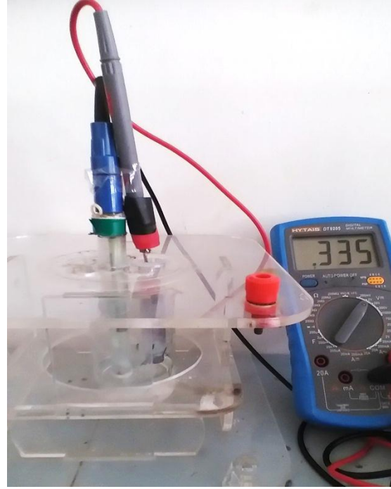
الشكل(2): مخطط توضيحي للخلية الكمونية المستخدمة
