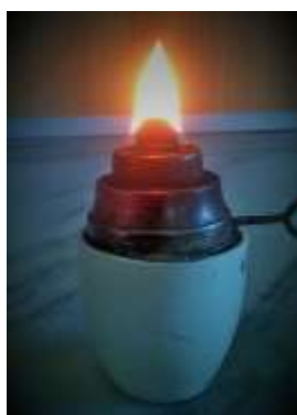
الشكل 7: اختبار الحرق للديزل الحيوي المحضر.
