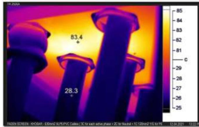
الشكل (2): الصورة الحرارية لمخارج الكيبلات من سقف علبة MDB لفهم عمق الظاهرة.
