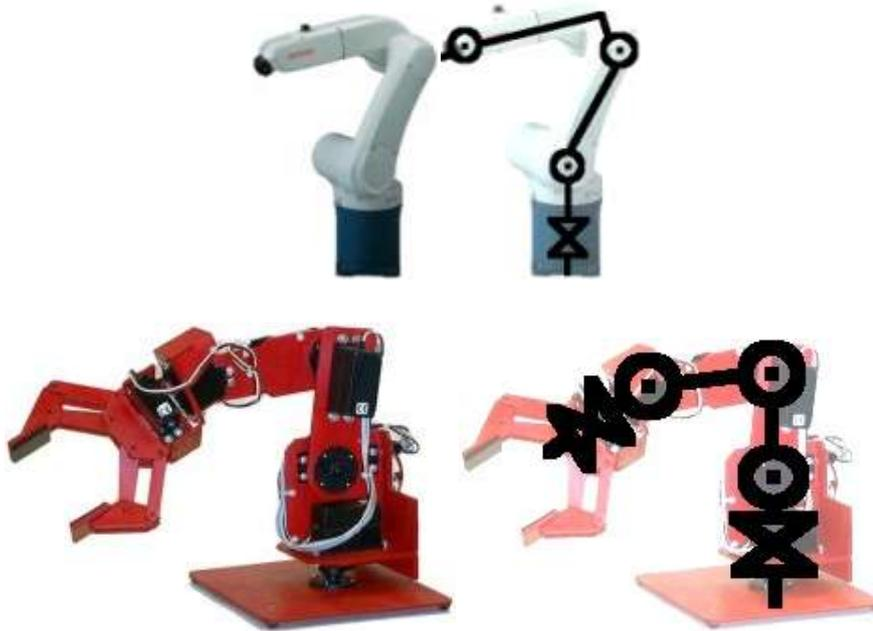
الشكل(1) - تمثيل الروبوتات بطريقة Denavit-Hartenberg
