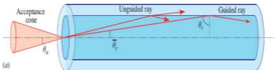
الشكل (3): فتحة النفوذ العددية وزاوية القبول والزاوية الحرجة في الليف الضوئي .
