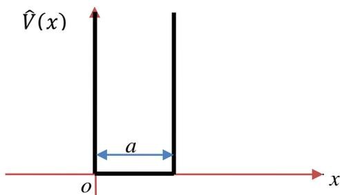
انطلقنا في توصيف النموذج النظري للجملة الفيزيائية الكمومية ذات سويتي الطاقة من شكل مُبسّط وذلك بفرض أنه مكوّن من إلكترون واحد، طاقته  $E_0$ ، موجود في حفرة كمون كمومية  $\hat{V}(x)$  على بُعد واحد  $x$  وعرضها  $a$ ، الشكل (1).
