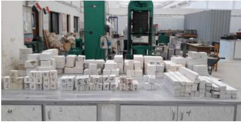
(الشكل 3): العينات المجهزة للدراسة الجيوتكنيكية في مخبر تجريب المواد - كلية الهندسة المدنية - جامعة تشرين.
