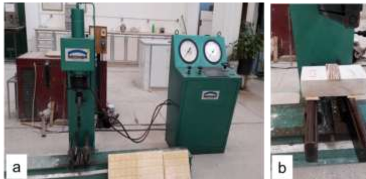
(الشكل 7): جهاز قياس معامل التمزق في مخبر تجريب المواد.
