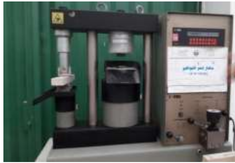
(الشكل 8): جهاز كسر المواشير في مختبر تجريب المواد - كلية الهندسة المدنية.
