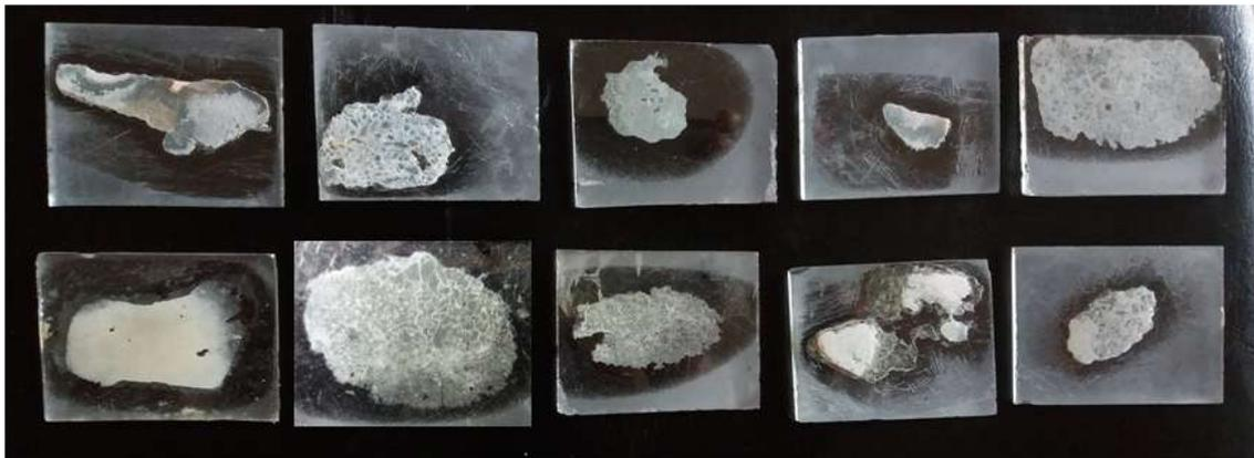
الشكل (4)، صور الشرائح الرقيقة المحضرة للدراسة المجهرية والمصنوعة من المقاطع العرضية للجيودات، قياس  $3 \times 2$  سم.
