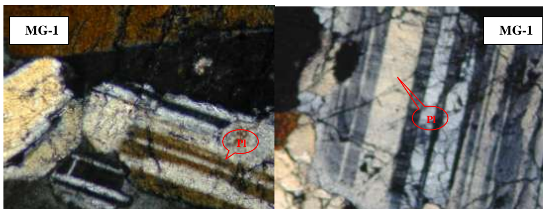
(الصورة:5)-صخر غابرو-بلورات من البلاجيوكلاز (pl) حيث تظهر التوأمية ، - العينة (MG-1).
