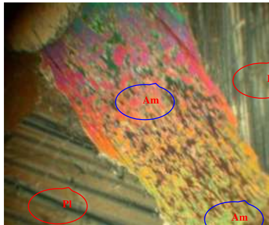
(الصورة: 21) - بلورة أمفيبول معرضة للتجوية ، العينة (MB-9)، تكبير \times 100 ، مع المحلل. Am-أمفيبول
