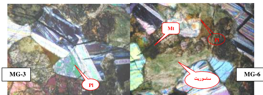
(الصورة:6)-صخر غابرو يظهر فيه نطاق الفساد بين بلورات البلاجيوكلاز وتشكل الساسوريت، العينة (MG-32) تكبير \times 100 . مع المحلل. Pl-بلاجيوكلاز ، Mt-مغنيتيت.
