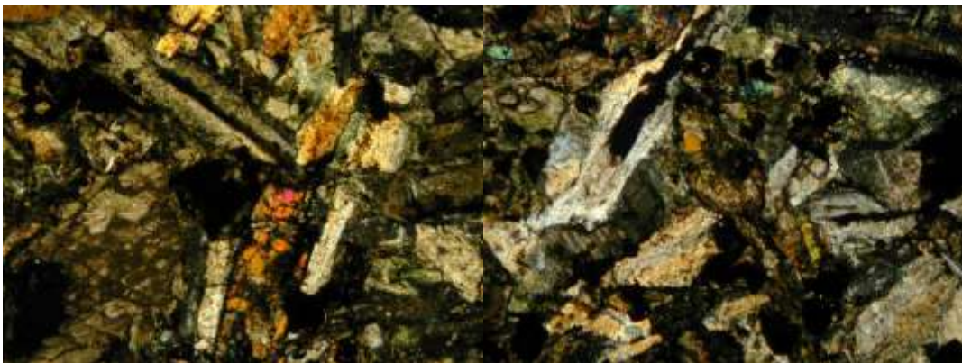
(الصورة 19)-فساد بلورات البلاجيوكلاز وبلورات البيروكسين، والمغنيتيت في صخر الدياباز، العينة (MB-7) تكبير \times 40 . مع المحلل.
