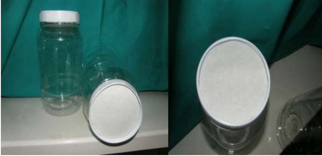
الشكل(1): مصاد الترسبات الغبارية ، أطباق من نترات السيلولوز مثبتة على عبوات بلاستيكية
