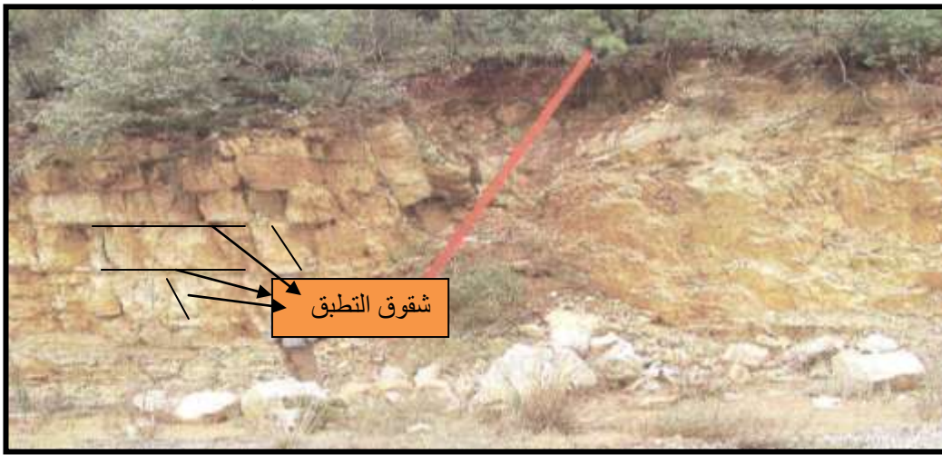
الصورة ( 3 ) : شق ضخم وكبير في المستوي السفلي لحوض التخزين في منطقة المشروع .
