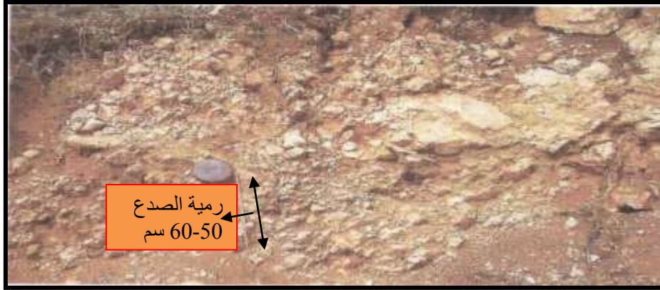
الصورة ( 1 ) : فالق على الجانب الأيمن للمحور الأول للسد.رمية الفالق تصل من (50-60 سم) منطقة الانزياح مملوءة بالكامل بغضار ناعم جداً.على الخارطة تظهر تحت رقم ( 1 ) .
