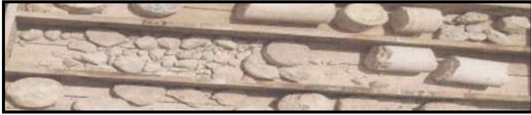
ث- العينات على عمق من ( 10.3-13.7 م ): صخور كلسية ضعيفة الدلمتة رمادية فاتحة اللون مشققة
