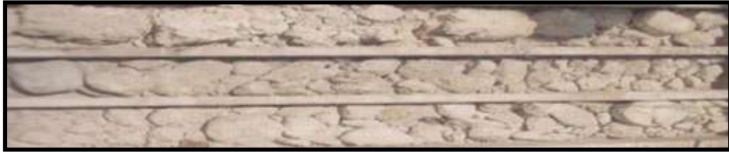
ج- العينات على عمق من ( 13.7-18.7 م ) ، من عمق ( 13.7-17.2 ) : صخور كلسية ضعيفة الدلمتة رمادية فاتحة مشققة بشدة ، ومن ( 17.2-18.7 ) : صخور غضارية مارلية ، بيجية اللون تتناوب مع طبقات قليلة الثخانة من صخور كلسية مارلية ضعيفة الدلمتة .
