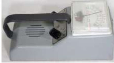
الشكل(2): جهاز قياس التلوث (Berthold-LB1200) وهو من صنع شركة Berthold الألمانية الرائدة في تقديم تكنولوجيا القياس.
