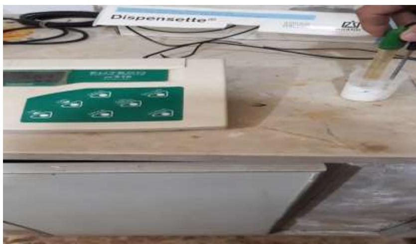
الشكل رقم (3) يوضح جهاز الـ PH meter.
