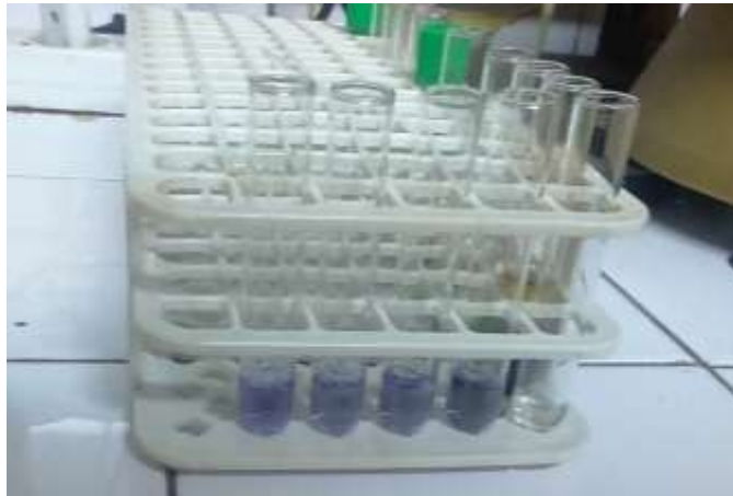
الشكل (3): قياس تركيز البروتين الكلي باختبار البيوريت
