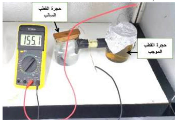
الشكل 3: قياس الجهد الكهربائي في خلية الوقود الميكروبية باستخدام جهاز قياس متعدد DT9205A.
