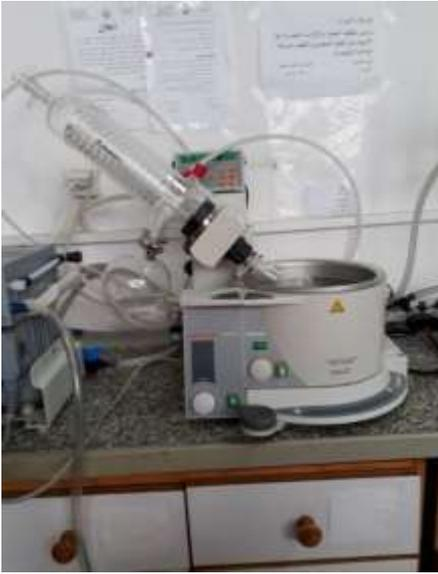
الشكل(4): المبخر الدوار (Rotary Evaporater)
