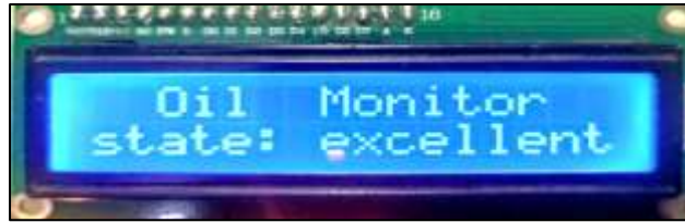
الشكل (3) شاشة LCD1602 المستخدمة.
