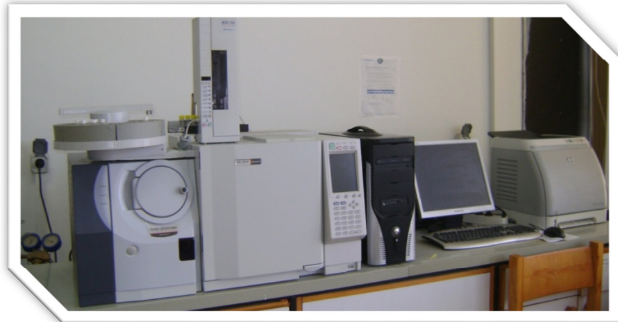
الشكل (4) جهاز الكروماتوغرافيا الغازية GC-MS QP2010 Plus
