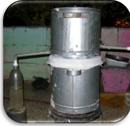
الشكل (2) جهاز التقطير المستخدم بعملية الاستخلاص
