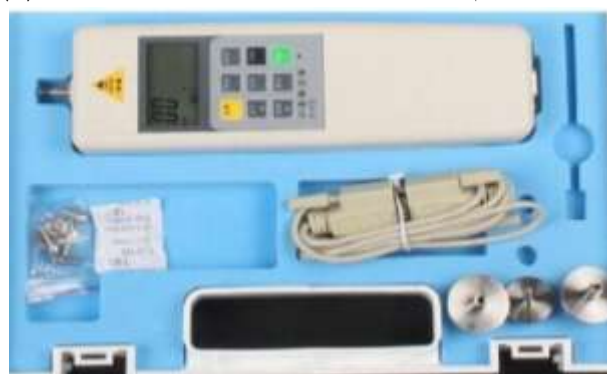
الشكل (3) جهاز قياس قوة الهلام من النوع Penetrometer موديل G4
