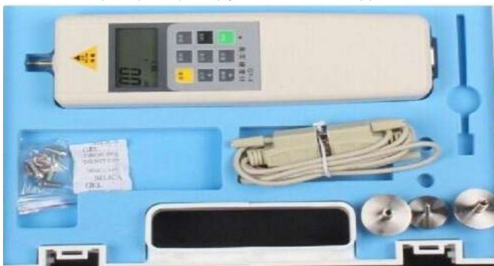
الشكل (3) جهاز قياس قوة الهلام من النوع Penetrometer موديل G4
