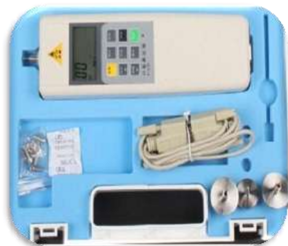
الشكل (3) جهاز قياس قوة الهلام من النوع Penetrometer موديل G4
