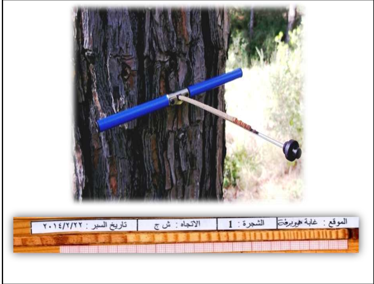
الشكل (4) مسبر بريسler المستخدم وعينة من السبرات المستخلصة بعد معاملتها
