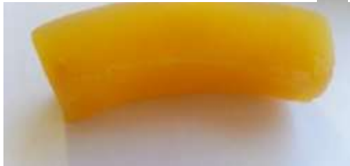
شكل (5) يوضح عينة عولجت بمحلول كلسي تركيزه 2.5% لمدة 720 د ثم بالمحلول السكري
