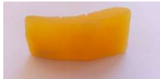
شكل (4) يوضح عينة عولجت بمحلول كلسي تركيزه 2.5% لمدة 480 د ثم بالمحلول السكري
