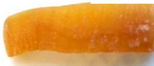
شكل (8) يوضح عينة عولجت بمحلول كلسي تركيزه 5% لمدة 480 ثمّ بالمحلول السكري شكل (3) يوضح عينة عولجت بمحلول كلسي تركيزه 5% لمدة 720 ثمّ بالمحلول السكري
