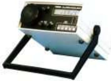
جهاز AB5 المستخدم في قياسات الرادون
