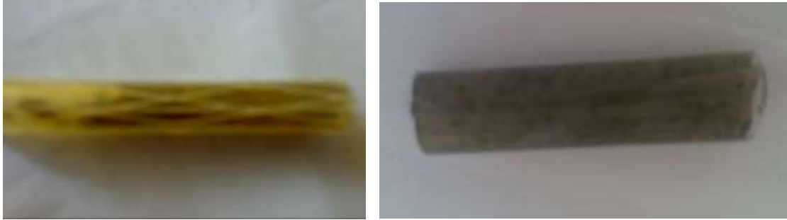
الصورة (1): قطع من أنابيب المياه تشكل على سطحها الداخلي غلاف حيوي.
