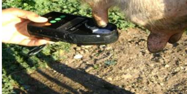
صورة رقم ( 3 ) : قياس مستوى الناقلية الكهربائية في حليب إحدى أبقار البحث
