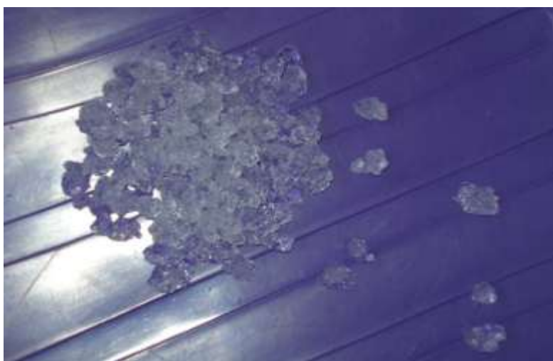
شكل (1) حبيبات البوليمير المنتفخة بعد امتصاصها للماء
