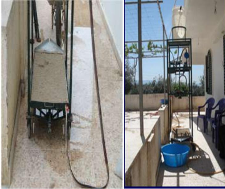
صورة رقم (1) توضح جهاز الإمطار الصناعي المستخدم
