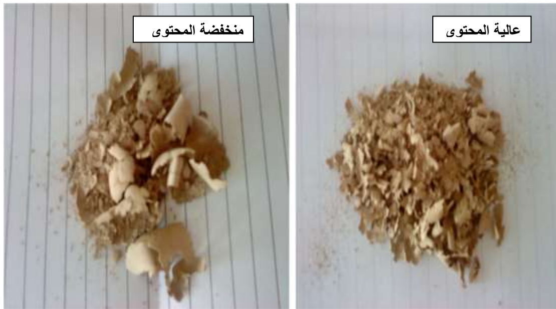
الصورة (3) يبين سماكة القشرة في التربة المنخفضة المحتوى والتربة العالية المحتوى بالمادة العضوية
