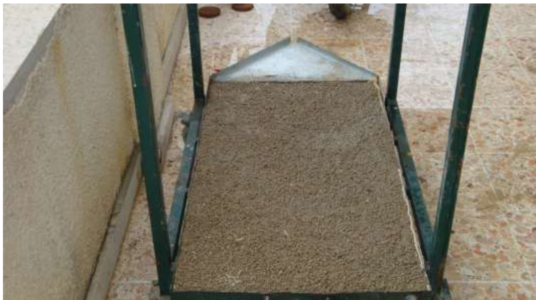
الصورة رقم (2) التربة بعد أن تم إشباعها من الأسفل وقبل تعريضها للمطر الصناعي
