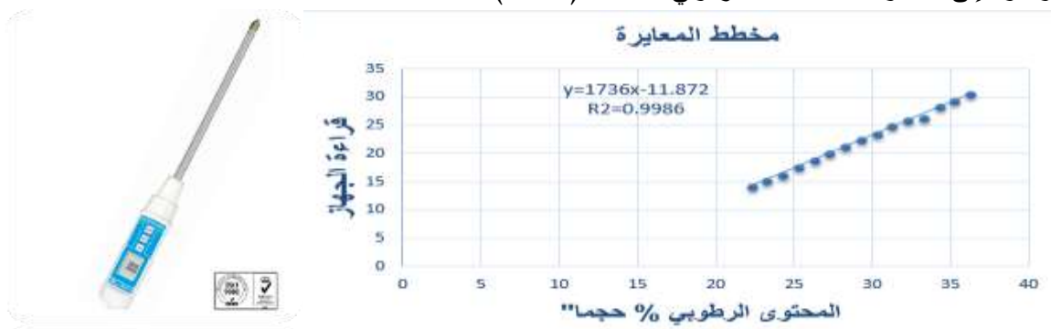
الشكل (1) يوضح منحنى المعايرة لجهاز قياس الرطوبة
