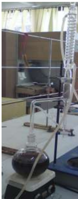
الشكل (3) جهاز تقطير الزيت الأساس
