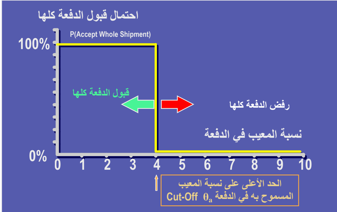
الشكل رقم (3) : توصيف العملية OC لدى المراقبة التامة L(p) - منحني التشغيل الأمثل
