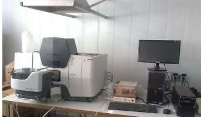
الشكل (7) جهاز الامتصاص الذري من النوع (Shimaldzu)
