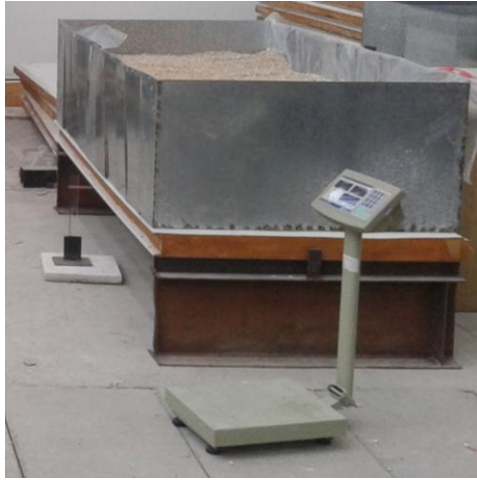
الشكل (7): نموذج جهاز تحميل العينات الموزع بانتظام على كامل اللوح المنفذ مخبرياً
