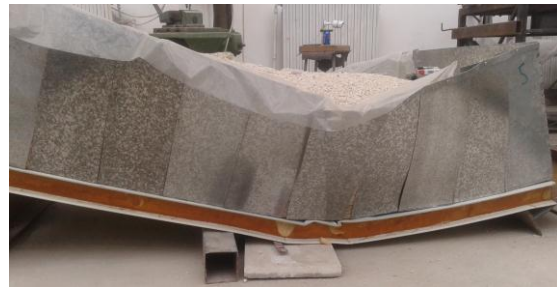
a: العينة 1 بعد الانهيار
