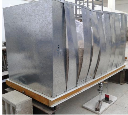
الشكل (7): نموذج جهاز تحميل العينات الموزع بانتظام على كامل اللوح المنفذ مخبرياً
