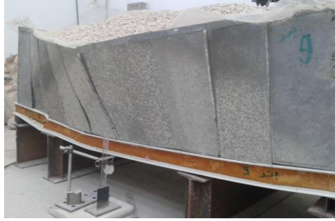
b: العينة 4 بعد الانهيار
