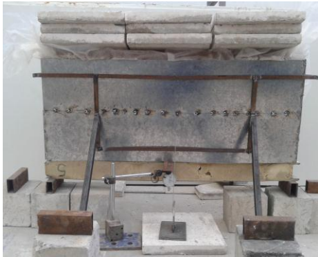
الشكل (8): نموذج جهاز تحميل العينات الموزع بانتظام
