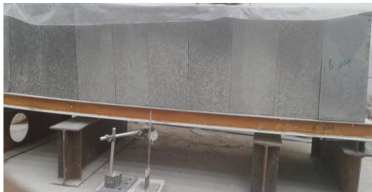
b: العينة 2 عند التحميل المرحلي قبل الانهيار
