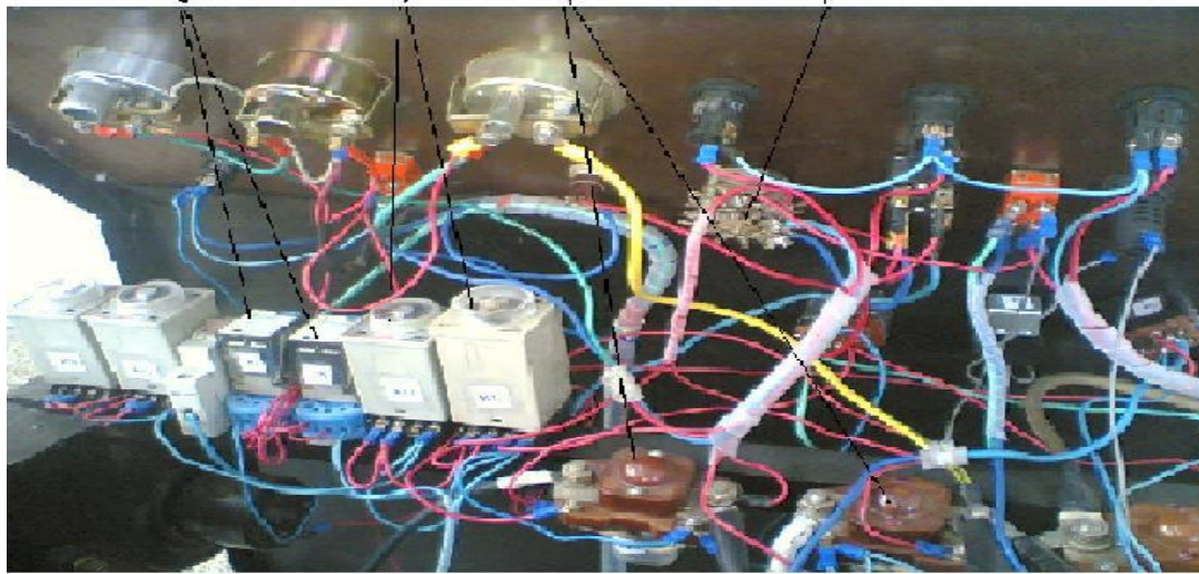
الشكل (11) عناصر التحكم بعمل منظومة الإقلاع المساعدة لمحرك العربة الفنية المطارية 1. مفتاح متعدد الوضعيات 2. قواطع تحكم لتشغيل المستهلكات 3. ريليه زمنية 4. ريليه تحكم.
