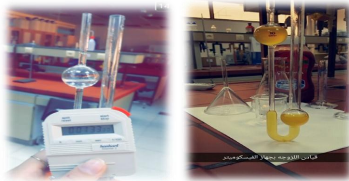
الشكل (4) جهاز قياس لزوجة زيت المحرك فيسكوميتز اوستوالد (Ostwald Viscometer)
