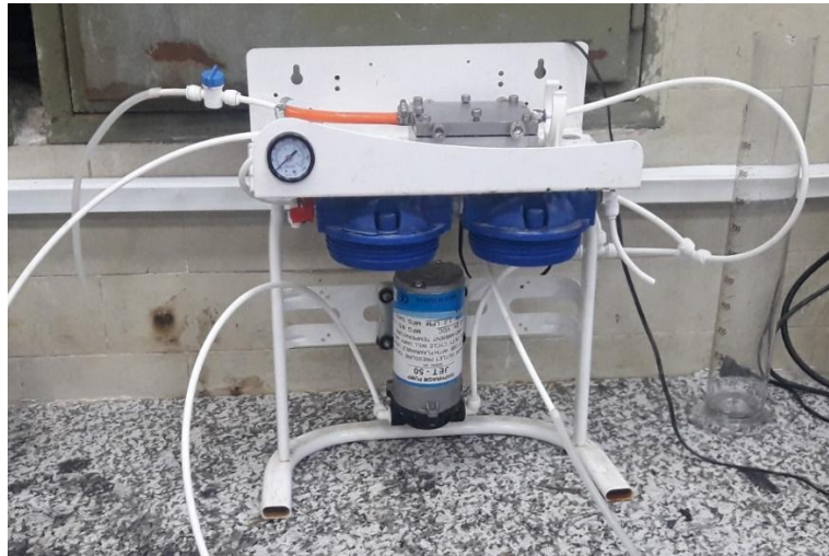
الشكل (1): جهاز ترشيح يعمل بطريقتي التيار المتصالب والنهاية الميتة (إيران-جامعة أصفهان التكنولوجية).
