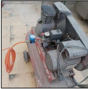
الشكل (7): ضاغط الهواء + منظم للضغط.
