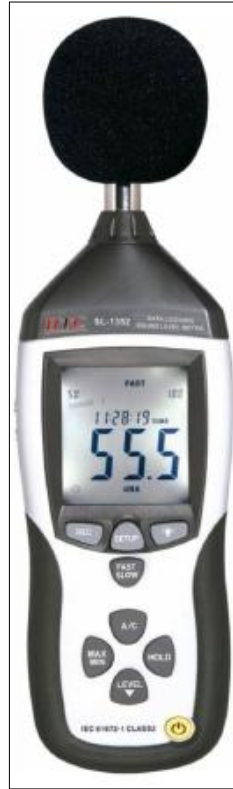
الشكل (1): جهاز قياس مستوى الشدة الصوتية المستخدم في هذه الدراسة [14].
