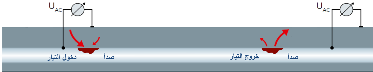
الشكل (9) قيمة التوتر U_R والتيار I_R المتحرضة في أنبوب معدني.
