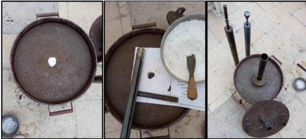
الشكل(1): تشكيل عمود التحسين المكون من الحصىيات وبودرة الكلس الجاف
