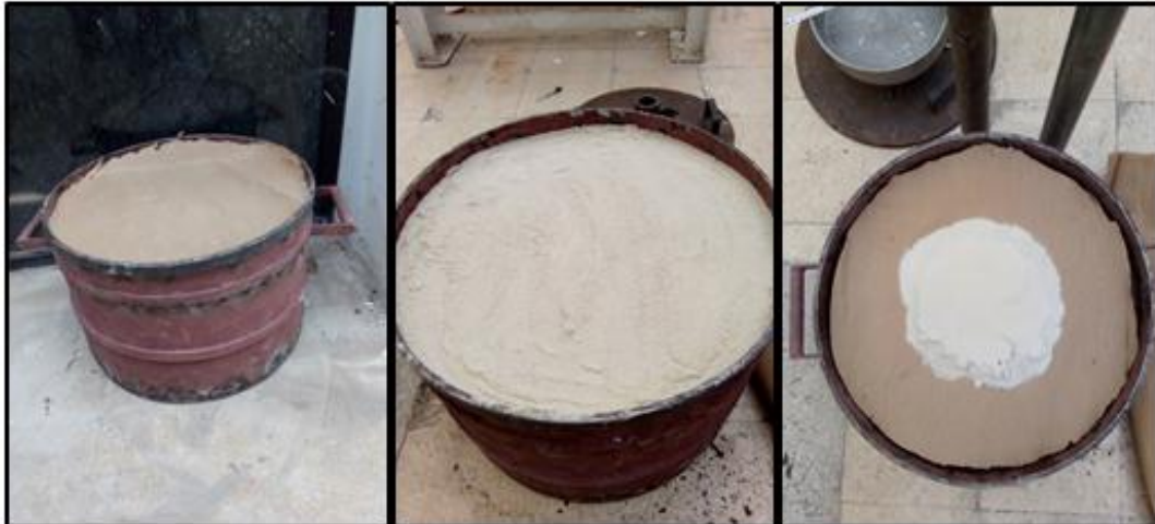
الشكل(2): تغطية سطح التربة بالرمل وتجهيز القالب للعملية الترطيب والتحميل
