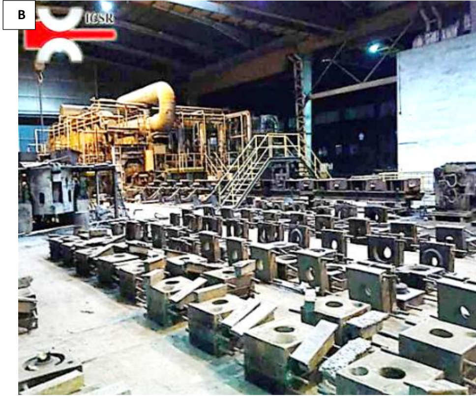
الشكل (1) أفران الصهر و B القوالب الرملية المجهزة للصب وترتيبها مع الأوزان الإضافية في الشركة الدولية لدرفلة الحديد في المدينة الصناعية بحسياء
