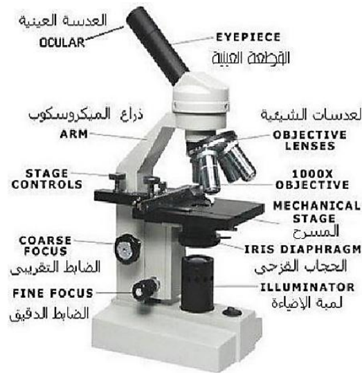
الشكل (3) المجهر الضوئي ماركة carl zeiss الألمانية
